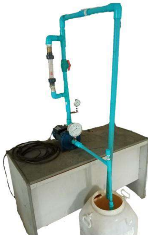
ภาพที่ 2 ชุดทดลองเพื่อหาอัตราการไหลของน้ำที่ใช้ในงานวิจัย
