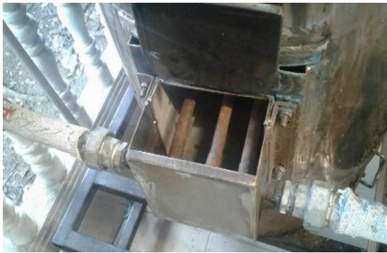
รูปที่ 6 แสดงสภาพภายในกล่องนำความร้อนที่ติดตั้งไว้ด้านข้างเตาเผาเชื้อเพลิงแข็ง ซึ่งภายในมีกลุ่มท่อทางน้ำเมื่อไม่มีวัสดุพูน
