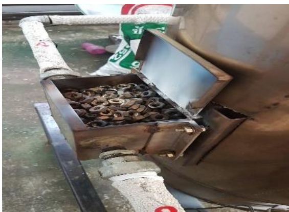
รูปที่ 7 แสดงสภาพภายในกล่องนำความร้อนเมื่อมีการเติมวัสดุพูนลงไปด้านใน
