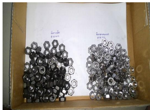
รูปที่ 4 แสดงลักษณะของวัสดุพูนที่ใช้เป็นนอตเหล็กและนอตสแตนเลสตัวเมีย ขนาด 10 mm.
