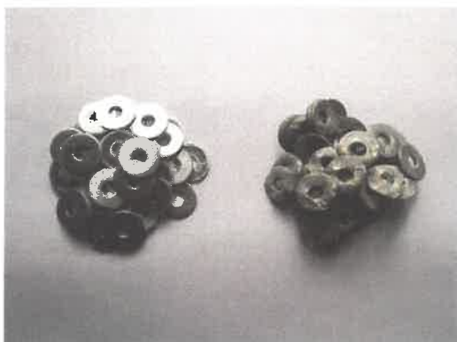
ภาพที่ 7 แสดงลักษณะของแหวนเหล็กชุบ สังกะสีขนาด 5/16 นิ้ว ที่ใช้เป็นวัสดุพรุณ ก่อนและหลัง การทดลอง
