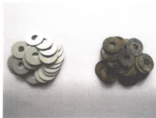
ภาพที่ 4 แสดงลักษณะของแหวนเหล็กธรรมดาขนาด 5/16 นิ้ว ที่ใช้เป็นวัสดุพรม ก่อนและหลัง การทดลอง
