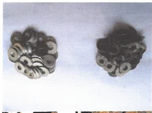
ภาพที่ 8 แสดงลักษณะของแหวนเหล็กชุบ สังกะสี ขนาด 3/8 นิ้ว ที่ใช้เป็นวัสดุพรุณ ก่อน และหลัง การทดลอง
