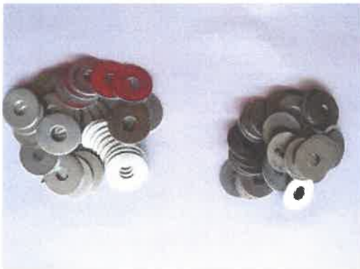
ภาพที่ 7 แสดงลักษณะของแหวนเหล็กชุบ สังกะสีขนาด 5/16 นิ้ว ที่ใช้เป็นวัสดุพรุณ ก่อนและหลัง การทดลอง
