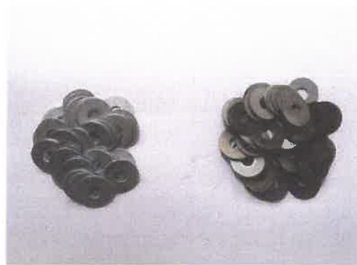
ภาพที่ 6 แสดงลักษณะของแหวนเหล็กชุบสังกะสี ขนาด 1/4 นิ้ว ที่ใช้เป็นวัสดุพรุณ ก่อนและหลัง การ ทดลอง
