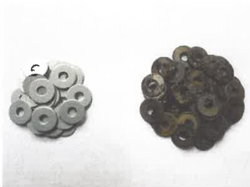
ภาพที่ 3 แสดงลักษณะของแหวนเหล็กธรรมดาขนาด 1/4 นิ้ว ที่ใช้เป็นวัสดุพรม ก่อนและหลัง การทดลอง
