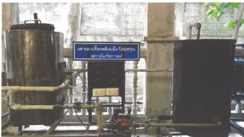
ภาพที่ 1 แสดงส่วนประกอบต่าง ๆ ของเตาเผาเชื้อเพลิงแข็งที่ใช้ในการทดลอง
